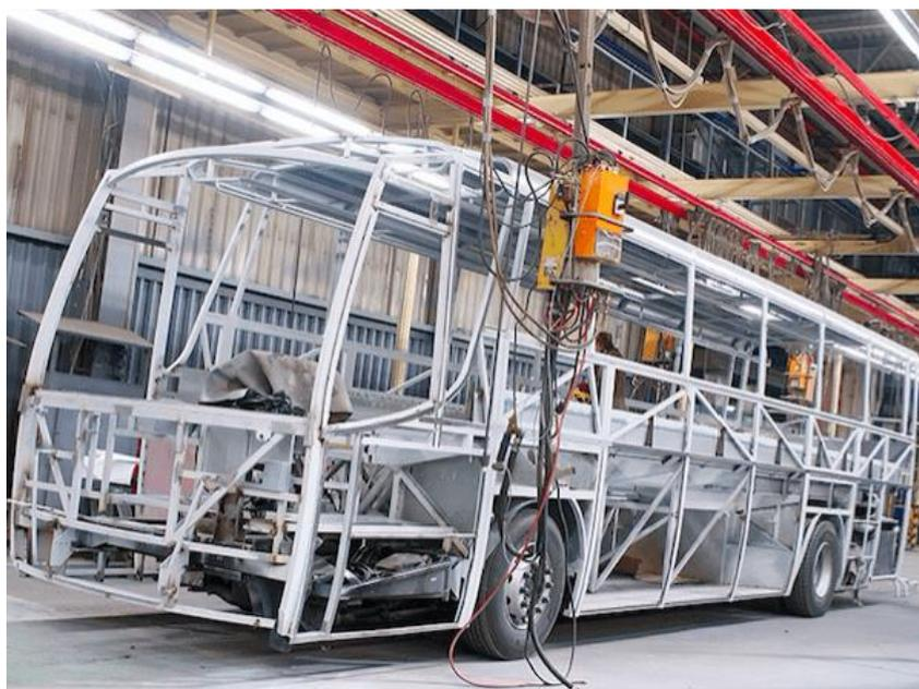
**Каркас** – основной скелет. От конструкции каркаса зависит в первую очередь безопасность пассажиров при возникновении аварийных ситуаций во время поездки.
